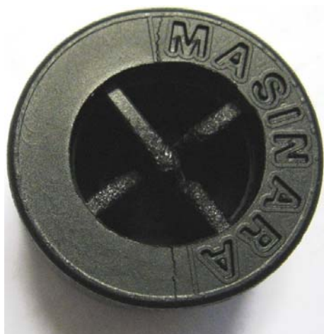
FOTO N° 6 Dopo -30° C: Inizio rottura a 256 daN (=251.14Kg)
