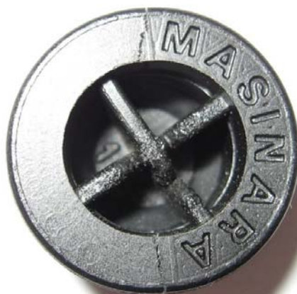
FOTO N° 4 T.A. 25°C: Inizio rottura a 266 daN (=260.95Kg)
